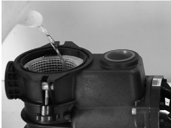
Ceban la bomba (si no riesgo de funcionamiento en seco). PERDIDA DE GARANTIA!!!
