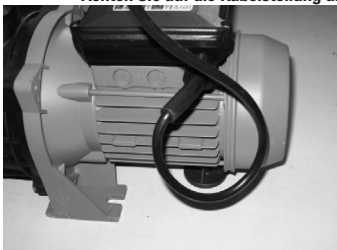
RICHTIG! Wassereintritt über Anschlusskabel wird verhindert
