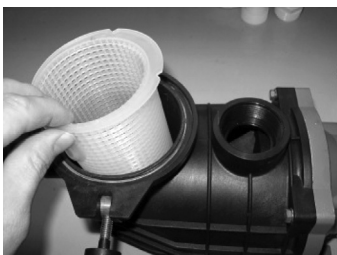
Tägliche Reinigung des Filterkorbes!
